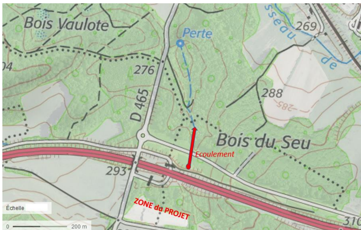
Figure 2 Situation de l'écoulement vers la perte du bois du Seu
